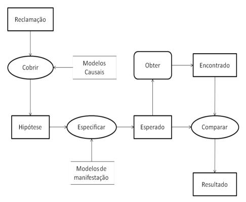
Figura 2 – Modelo de Tarefa para o Diagnóstico Fonte: adaptado de SCHREIBER et al. (2002)
