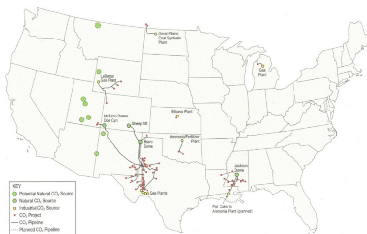
Figura 1 – Localização nos EUA dos projetos correntes de EOR com CO 2 e dutovias. Fonte: National Energy Technology Laboratory (NETL, 2010).
